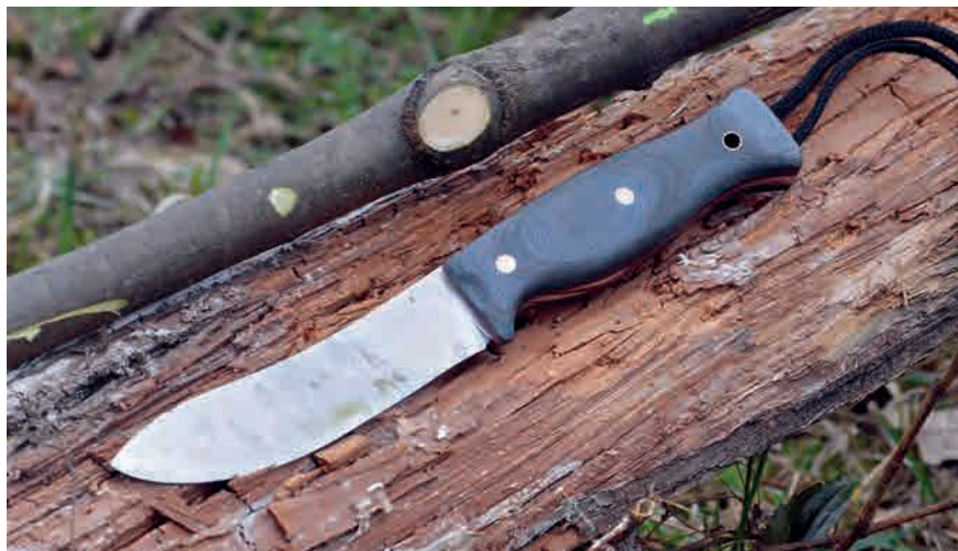
Hudra József Elmax csúcsacélos, micarta markolatú, rendkívül igényes, strapabíró vadászkésé, ami a Fallkniven cég Professional Hunter Knife késének továbbgondolásából született (fotó: dr. Fuisz Tibor István)
