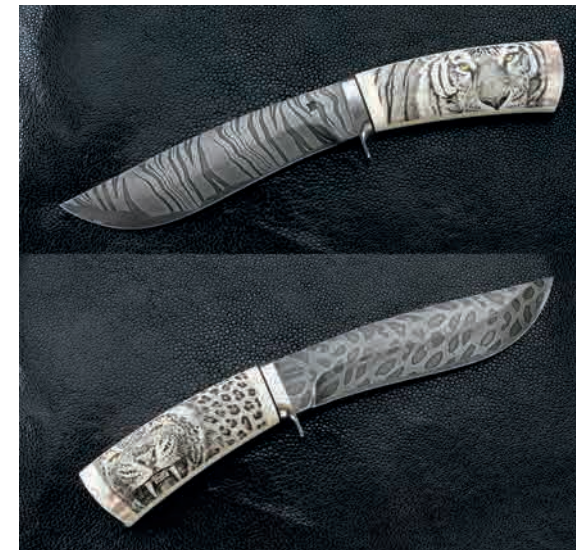
Fazekas József kovácsmester egyik oldalon tigriscsíkos, másik oldalon párdücpettyes mozaik damaszk acél pengéjű kése. A penge mintázatára rimel a markolat állatábrázolása is (Fotó: Ifj. Fazekas József)
